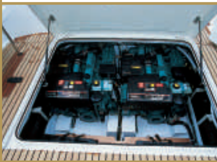
Accès au moteur facile par un large capot intégré dans le plancher de cockpit Easy access to engines through a wide flush hatch
